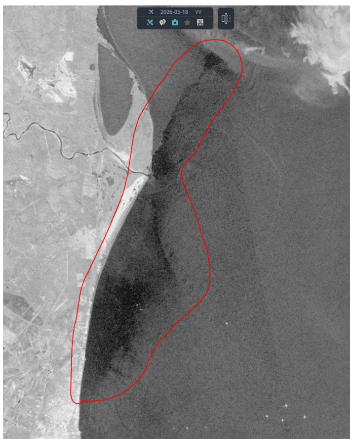
Рис. 13. Загрязнения с речным стоком, на РЛИ Sentinel-1A/1C 18.05.2026. © ESA
