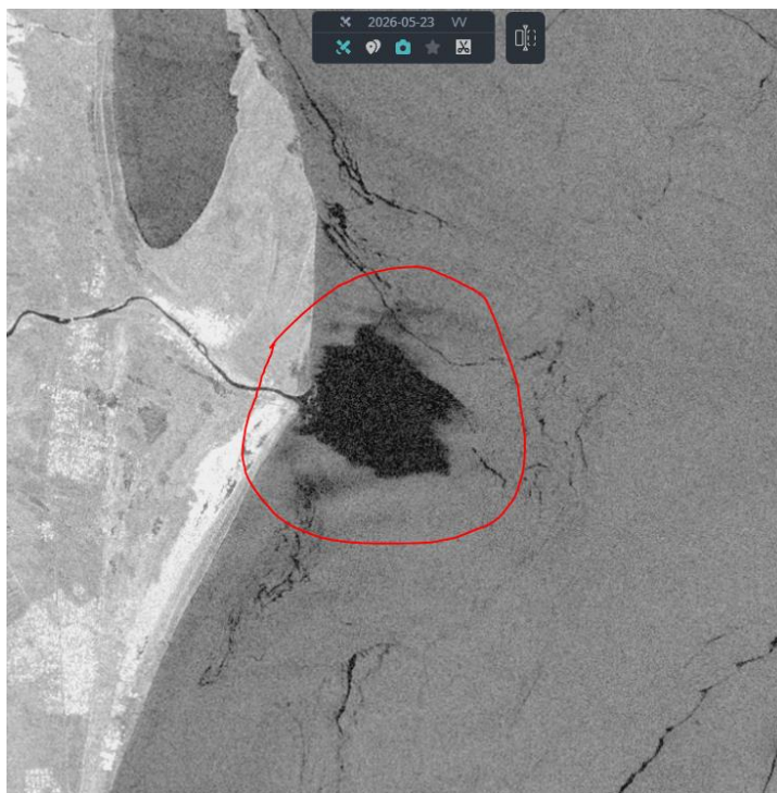
Рис. 14. Загрязнения с речным стоком, на РЛИ Sentinel-1A/1C 23.05.2026. © ESA
