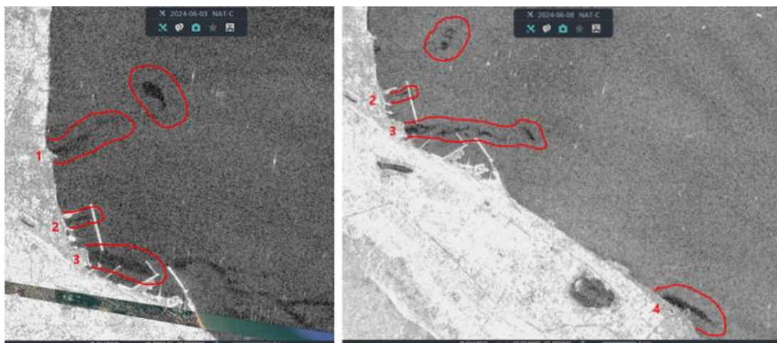
Рис. 6з. Фрагменты РЛИ спутника Sentinel-1 на акваторию Махачкалинской агломерации от 3.06.2024 (слева) и 8.06.2024 (справа). Основные источники загрязнений: (1) нефтехранилище, (2) нефтегавань, (3) судоремонтный завод, (4) выпуск сточных вод. © ESA
