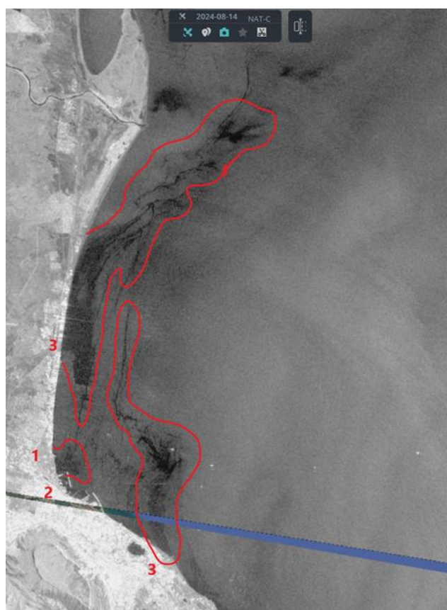
Рис. 6п. Фрагмент РЛИ спутника Sentinel-1 на район Махачкалинской агломерации от 14.08.2024. Основные, наиболее вероятные источники обширных пленочных загрязнений: (1) нефтехранилище, (2) нефтегавань, (3) река-канал Шурозень и другие загрязнения, вынесенные с речным стоком. © ESA
